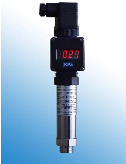
ST925压力变送器采用进口的高性能硅压阻式压力传感器及SMD电子技术制作，具有宽温度自动补偿功能，使其具有较高的精度与稳定性。
