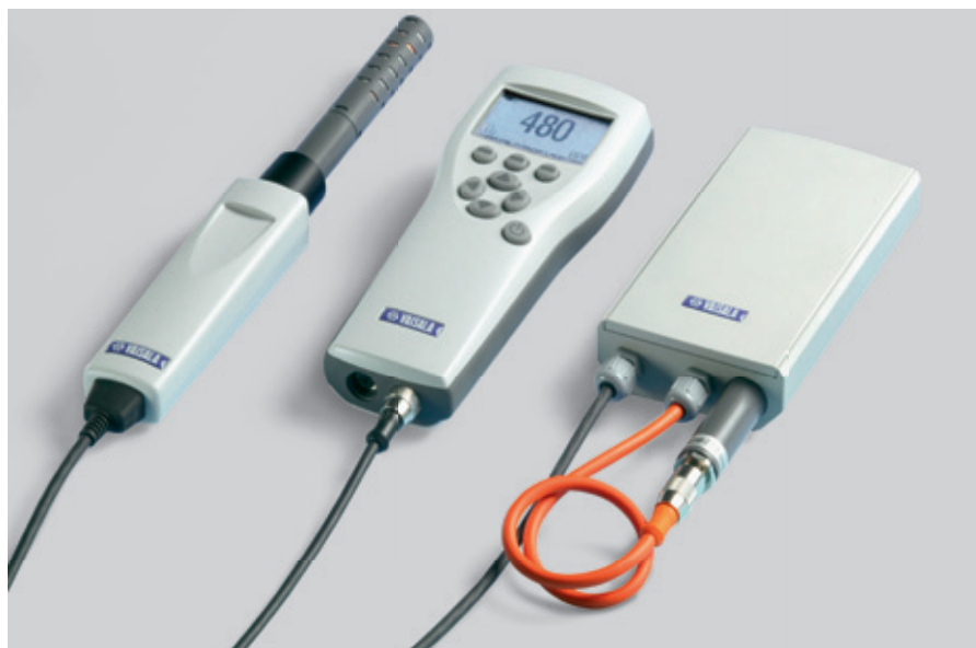
维萨拉CARBOCAP®手持式二氧化碳测量仪GM70是要求苛刻的专业人士的首选。仪表由显示表头(中)和探头组成,可以带手柄(左),也可以带抽气泵(右)。
