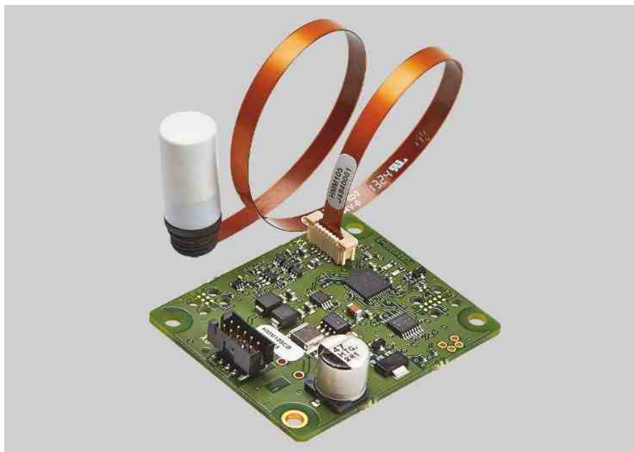
维萨拉HUMICAP®数字湿度模块HMM105。
